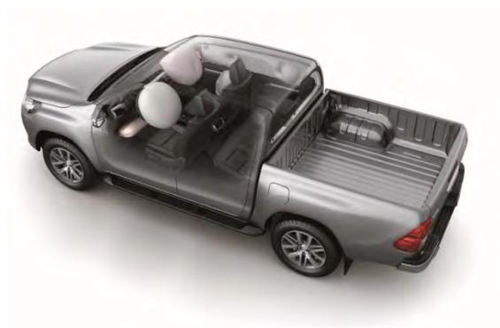
Desde lo estructural, la carrocería no solamente cuenta con barras de protección lateral en las puertas sino que a su vez, fue diseñada para absorber impactos frontales y laterales. Por otro lado, la estructura del chasis fue diseñada para absorber impactos frontales mejorando la absorción de energía respecto de la generación anterior.
