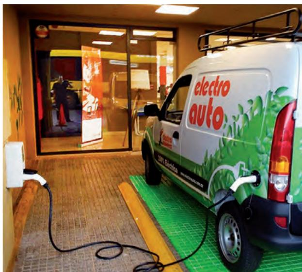
La empresa misionera "Electro Auto" viene realizando con éxito la conversión para hacer autos eléctricos, desde un vehículo chico hasta una camioneta (hasta de 3.000 kg máximo), que luego pueden cargarse con el enchufe de una casa y una vez instalado -aseguran-, se gasta solo el 10% en uso y mantenimiento comparado con un naftero.
