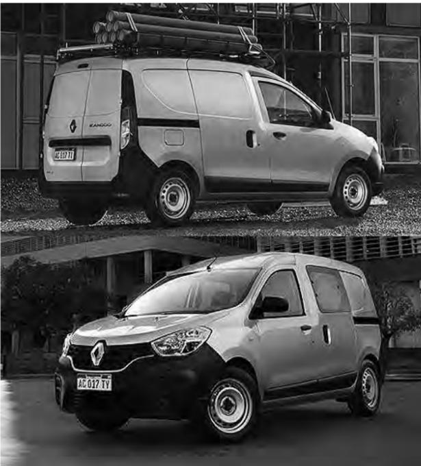
**En 2 asientos:** hay disponibles hasta 4 versiones, dependiendo del nivel de equipamiento y motorización: un nuevo motor nafta 1.6 SCe de 114 CV y un nuevo motor diésel 1.5 dCi de 89 CV.
