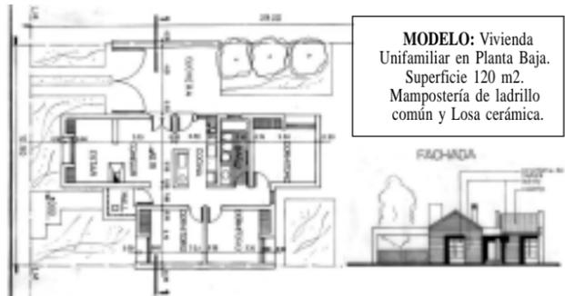
MODELO: Vivienda Unifamiliar en Planta Baja. Superficie 120 m2. Mampostería de ladrillo común y Losa cerámica.
