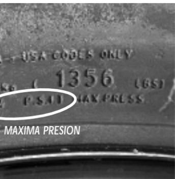
ta en un lado del neumático. Nunca excedas esta presión. A menor presión se incrementa la temperatura del neumático y el calor excesivo los daña severamente.
