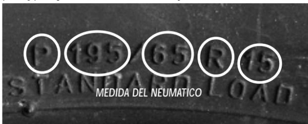
«P» indica que el neumático es para un vehículo de pasajeros. «195» es el ancho del neumático en milímetros. «65» indica que la altura del perfil del neumático es del 65% de la anchura. «R» que es radial. «15» que encaja sobre llantas de 15 pulgadas.
