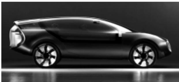
Asentado sobre llantas de 7 brazos de aluminio y 23 pulgadas, Ondelios muestra una imagen perfilada. Como si fuera una hélice de avión, el diseño de las llantas permite encaminar el flujo de aire a los costados de la carrocería evitando de esta manera las turbulencias aerodinámicas.
