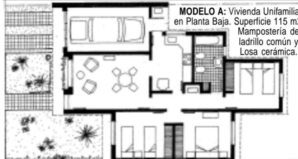
**MODELO A:** Vivienda Unifamiliar en Planta Baja. Superficie 115 m2. Mampostería de ladrillo común y Losa cerámica.
