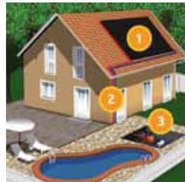
1 pantalla solar, 2 tuberías, 3 bomba
