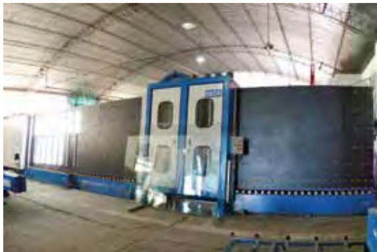
Máquina de origen chino, marca “Deca”, para la fabricación industrial de DVH (Doble Vidriado Hermético).
