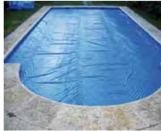
Las mantas o cobertores térmicos son una cubierta de polietileno con burbujas de aire confinado que se colocan sobre la piscina. La baja densidad y las burbujas de aire permite su flotación.
